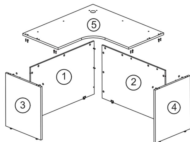
PARA FACILITAR A MONTAGEM INICIE FIXANDO FUNDO ESQ INFERIOR (1), FUNDO DIR INFERIOR (2), LATERAL ESQ INFERIOR (3), LATERAL DIR INFERIOR (4) E TAMPO INFERIOR (5).
