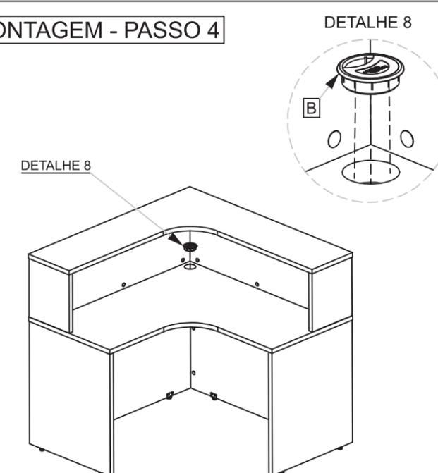
PARA FINALIZAR, APÓS A MONTAGEM COMPLETA DO BALCÃO INSERIR O PASSA FIO (B) CONFORME DETALHE 8.
