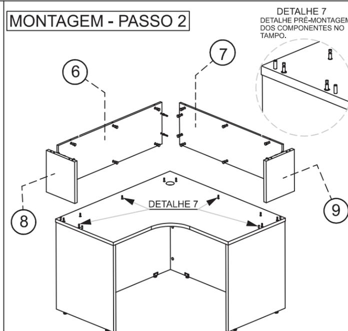
APÓS A MONTAGEM COMPLETA DA PARTE INFERIOR DO BALCÃO, INICIE A MONTAGEM DOS COMPONENTES NO TAMPO INFERIOR(5) CONFORME INDICA A PRÉ-MONTAGEM, SEGUINDO A MONTAGEM PASSO - 1 , FAÇA A MONTAGEM DOS FUNDOS(6,7) E DAS LATERAIS(8,9) SUPERIORES CONFORME MONTAGEM PASSO - 2 E APÓS A FIXAÇÃO DAS PEÇAS SUPERIORES, INSERIR O TAMPO SUPERIOR(10) NO BALCÃO FAZENDO A FIXAÇÃO TOTAL DOS COMPONENTES CONFOROME MONTAGEM PASSO - 3.
